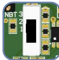
Мал. 5 Перемикач вибору аналогового виходу
