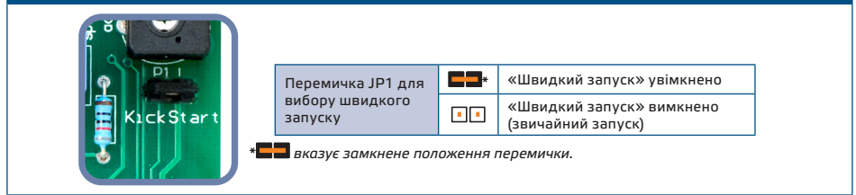
Мал. 4 Перемичка для вибору режиму запуску
