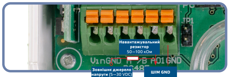
Рис. 6 Підключення ШІМ (з відкритим колектором) (JP1 відключений)
