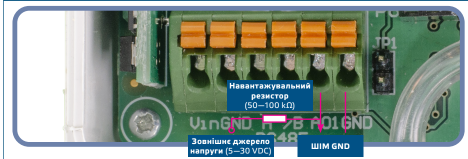
Мал. 6 Підключення ШІМ (з відкритим колектором) (JP1 відключений)
