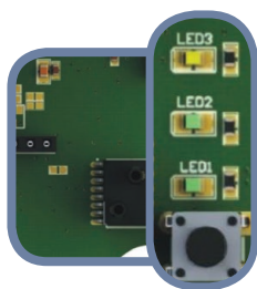
Мал. 7 Калібрування датчика та тактовий перемикач реєстрів Modbus та їх індикація
