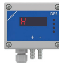
б. Індикація скидання Modbus
