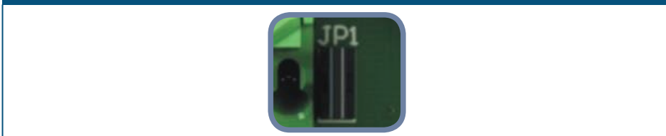
Мал. 4 Внутрішній навантажувальний резистор (JP1)
