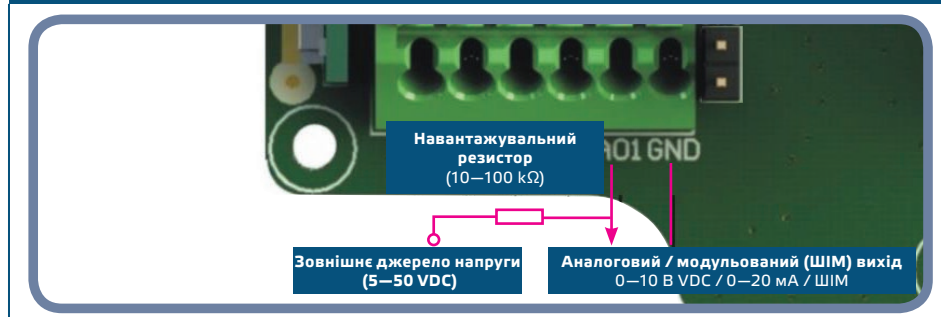
Мал. 5 ШИМ (Відкритий колектор) з'єднання
