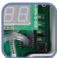
Мал. 8 Калібрування датчика та тактовий перемикач регістрів Modbus та їх індикація
