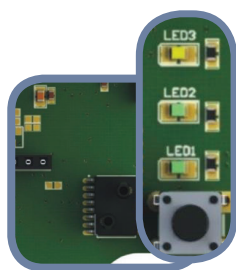
Мал. 6 Калібрування датчика та тактовий перемикач реєстрів Modbus та їх індикація
