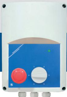
SER-1 serisi transformatörlü fan hız kontrol cihazları, çıkış volajını değiştirerek tek fazlı voltaj kontrol edilebilir motorların dönüş hızını düzenlerler. Bir otomatik transformator ile donatılmışlardır ve hızı beş adımda manuel olarak kontrol ederler. Kullanılan teknoloji, mükemmel bir sinüzoidal şeke sahip düzenlenmiş bir çıkış volajı sağlar. Kontrolörler, duman tahliyesi için bir acil durum düğmesine sahiptir.
