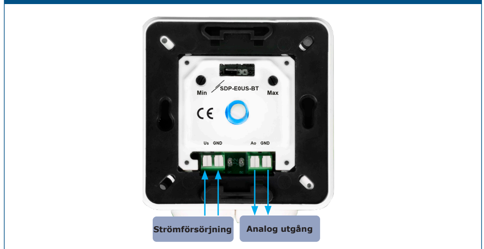
Bild 1 Ledningar och förbindelser
