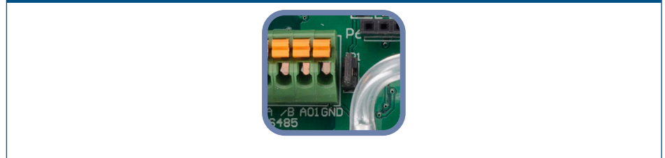
Bild 5 Pull-up motståndbygel ansluten
