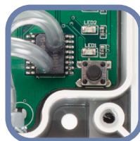
Bild 8 Taktomkopplare och indikering för sensorkalibrering och återställning av Modbus register
