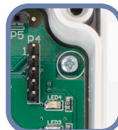
Bild 10 Återställningsbygel för Modbus holding register
