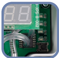
Fig. 8 – Taktomkopplare för sensorkalibrering och återställning av Modbus register - indikeringar
