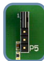
Fig. 6 Modbus Holding Register återställningsbygel (P5)
