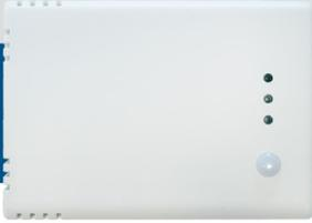
RSTHX-3-serien är rumsgivare som mäter temperatur, relativ luftfuktighet och omgivande ljus. De har ett brett utbud av strömförsörjning med låg spänning och tre analoga / modulerande utgångar. Alla parametrar är tillgängliga via Modbus RTU.
