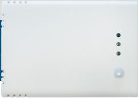
RSMFX-3-serien är multifunktionella rumsgivare som mäter CO<sub>2</sub> koncentrationsnivåer, temperatur, relativ luftfuktighet och omgivande ljus. De har tre analoga/modulerande utgångar för temperatur, relativ luftfuktighet och CO<sub>2</sub> och ett brett utbud av lågsämningsagregat. Alla parametrar är tillgängliga via Modbus RTU.
