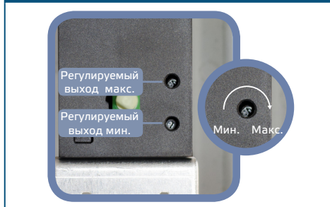
Рис. 5 Мин. и макс. триммеры выходной скорости
