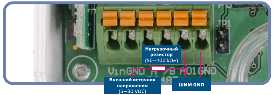
Рис. 6 Подключение ШИМ (с открытым коллектором) (JP1 отключен)
