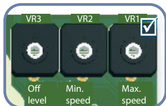
Рис.6 Подстроечный резистор макс. скорости
