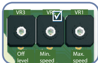
Рис. 7 Подстроечный резистор мин. скорости
