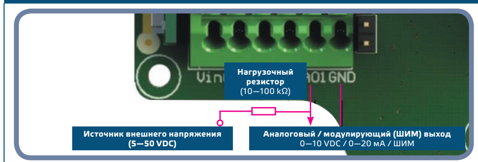
Рис. 5 ШИМ (открытый коллектор) подключение
