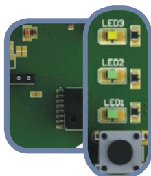
Рис. 6 Индикатор калибровки датчика и кнопка сбросов параметров Modbus-a
