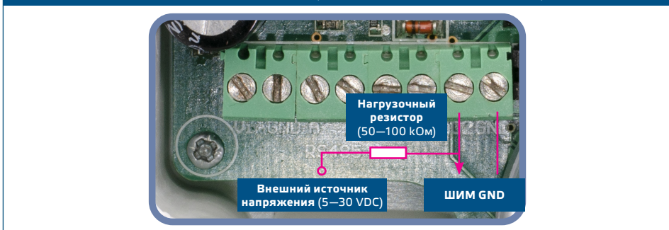
Рис. 6 Пример подключения ШИМ (с открытым коллектором)
