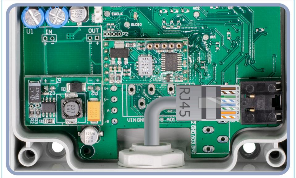
3. Закройте корпус и закрепите его винтами. Затяните кабельный сальник, чтобы сохранить степень защиты IP корпуса.
