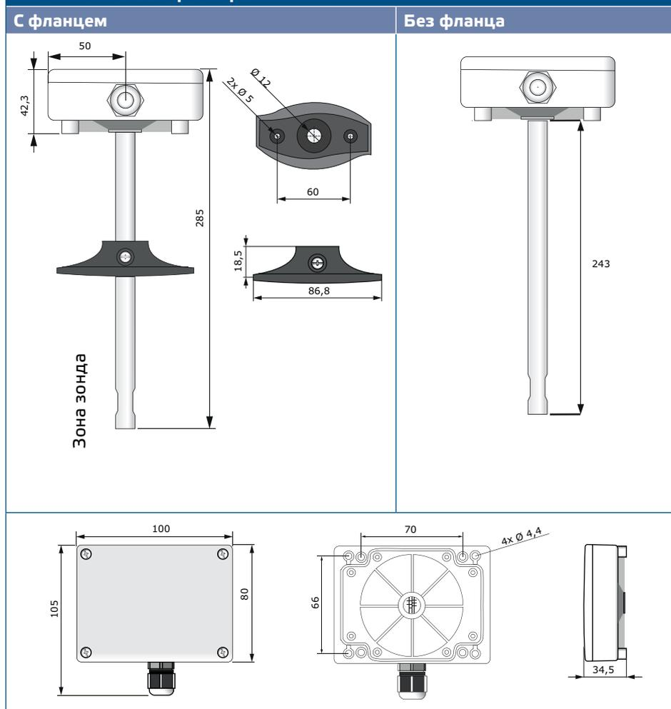
**Рис. 2 Монтажное положение**
