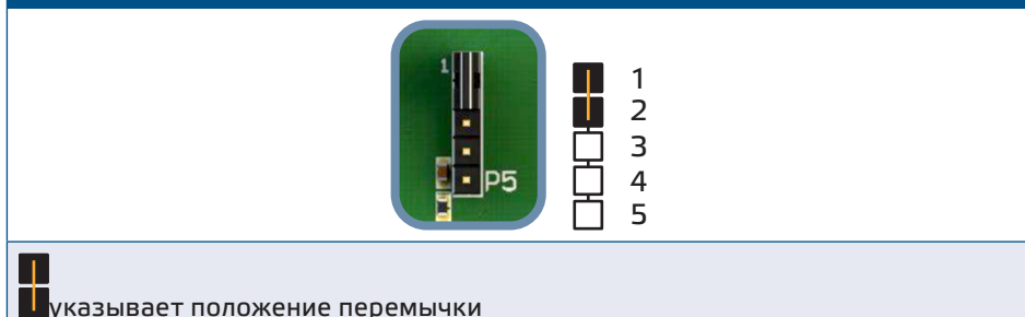
Рис.6 - Перемычка сброса регистров Modbus *
