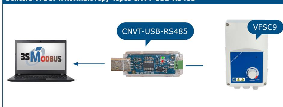
Рис. 1 Пример подключения электронного регулятора скорости вентилятора Sentera VFSC9 к компьютеру через CNVT-USB-RS485
