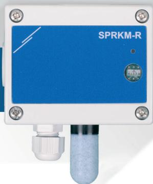
SPRKM-R это многофункциональные датчики газа, которые измеряют температуру, относительную влажность, CO и LPG (пропан C<sub>3</sub>H<sub>8</sub>). Питание через Modbus, все параметры доступны через Modbus RTU.
