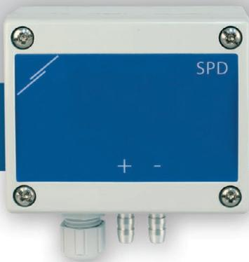
Серия SPD - это компактные двухдиапазонные дифференциальные преобразователи давления, имеющие аналоговый / цифровой выход для каждого датчика и связь Modbus RTU. Преобразователи имеют два встроенных современных кремниевых сенсора давления с восемью переключаемыми диапазонами измерения. Пьезорезистивные преобразователи SPD компенсируют температуру и давление, обеспечивая высокую степень точности и надежности. Каждый датчик имеет кнопку для ручной калибровки нулевой точки и регулируемого смещения.
