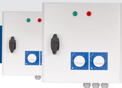
Трансформатор SC2A4 регулирует скорость вращения однофазных двигателей, путем изменения выходного напряжения. Они оборудованы автотрансформаторами и управляют скоростью вручную в пять шагов. Регулятор позволяет выбрать две оптимальные скорости вращения двигателя и переключать их (например, управление день / ночь). Таким образом можно экономить электроэнергию. Используемая технология обеспечивает регулируемое выходное напряжение с идеальной синусоидальной формой.
