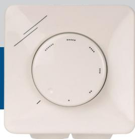
Потенциометр MTP-G010-AT предназначен для управления ЕС вентиляторами / двигателями и приводами. Для него требуется напряжение питания 24 VDC или 24 VAC, он обеспечивает плавный выходной сигнал, который может быть установлен поворотной ручкой с положением Выкл. Диапазон выходного сигнала регулируется двумя внутренними триммерами между  $V_{min}$  (0–7 VDC) и  $V_{max}$  (3–10 VDC). Он подходит для настенного (IP44) и встроенного монтажа (IP54).
