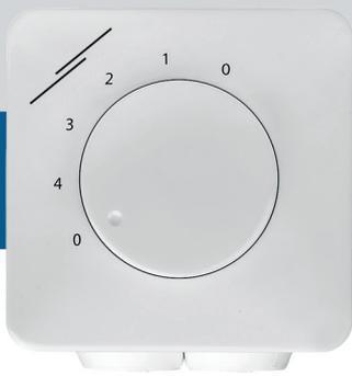
Регуляторы ECA специально разработаны для управления потолочными вентиляторами. Они имеют четыре положения, которые переключаются параллельно для изменения напряжения, подаваемого на двигатель. Контроллеры подходят для встроенного (IP44) и поверхностного монтажа (IP54).
