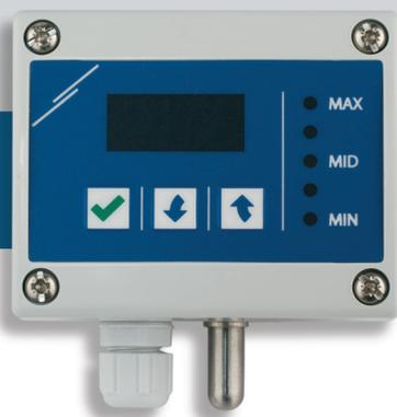
Серия DTAP - универсальные программируемые контроллеры. Они имеют температурный и / или аналоговый вход (0—10 VDC / 0—20 мА / ШИМ) и обеспечивают пропорциональный аналоговый выход с двумя заданными значениями, цифровой индикацией и индикацией выхода со светодиодами. Контроллер DTAP оснащен функцией программирования заданных значений для входов и выходов.
