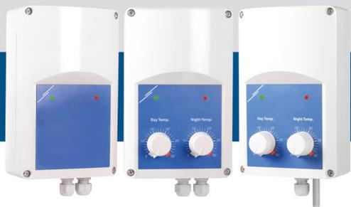
Серия AH2X1-6 - регулятор электрического нагрева для однофазного или двухфазного электрического нагревателя. Они используют пропорциональный по времени контроль: соотношение времени включения и выключения изменяется, чтобы соответствовать требованиям нагрева. Ток переключается на симисторе, что минимизирует износ, в то время как повышенная точность управления снижает затраты на электроэнергию.
