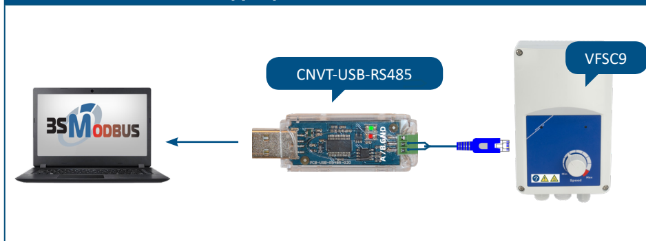
Рис. 1 Пример подключения электронного регулятора скорости вентилятора Sentera VFSC9 к компьютеру через CNVT-USB-RS485
