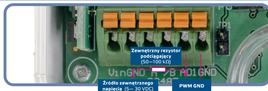
Rys. 6 Połączenie PWM (otwarty kolektor) (JP1 odłączony)
