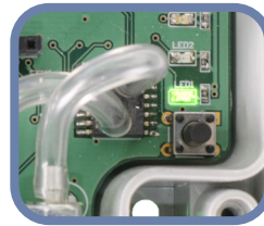
Fig. 5 Indicatie voor voeding / modbuscommunicatie
