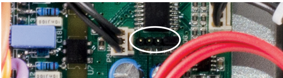
Fig. 4 P7 Header voor keuze tussen "Verwarmen" of "Koelen"
