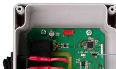
Jumper geplaatst - Koelen
