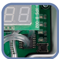
Fig. 8 Microschakelaar voor reset van de modbusregisters en voor de kalibratie van de sensor
