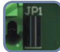
Fig. 4 Interne pull-up weerstandsjumper JP1
