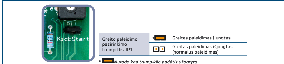
Fig. 4 Paleidimo režimo pasirinkimo trumpiklis
