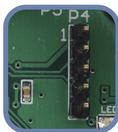
Fig 10 Modbus holding registrų atkūrimo trumpiklis
