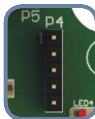
Fig. 9 Modbus valdymo registrų atstatymo trumpiklis
