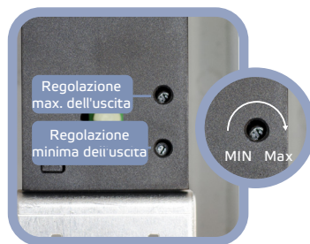
Fig. 5 Trimmer per velocità di uscita minima e massima
