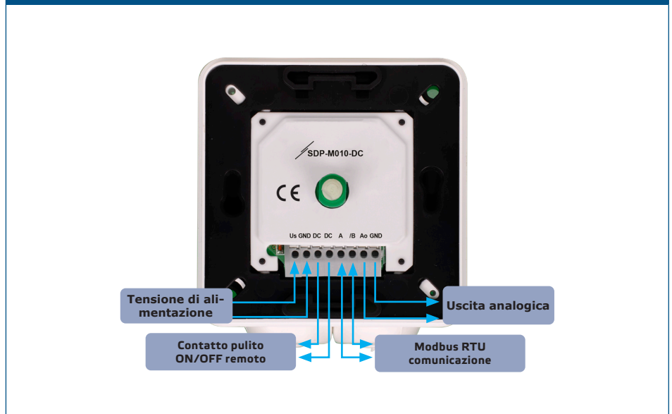
Fig. 1 Cablaggio e connessioni
