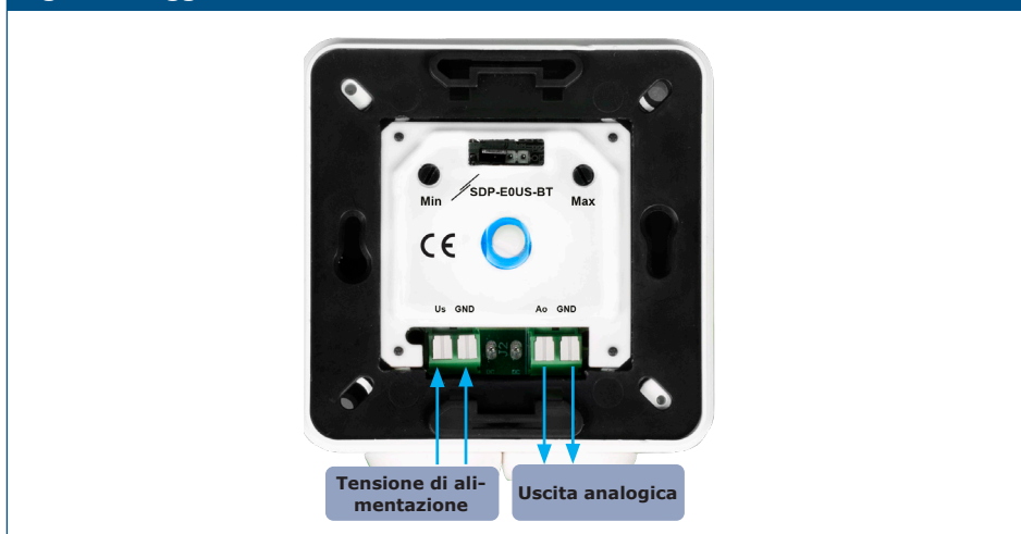
Fig. 1 Cablaggio e connessioni
