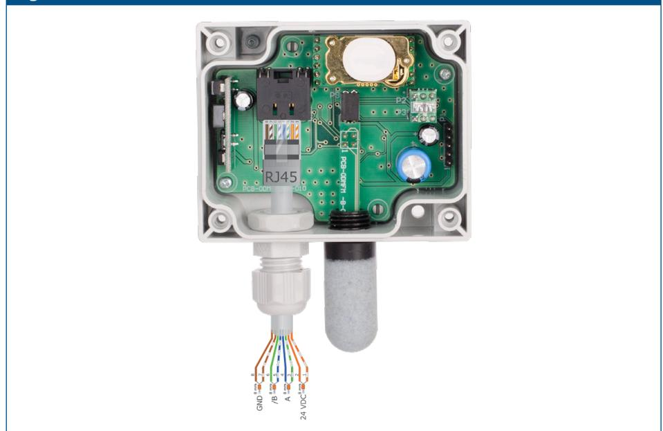
4. Chiudere il coperchio e fissarlo con le viti. Stringere il pressacavo per mantenere il grado di protezione IP del contenitore.
