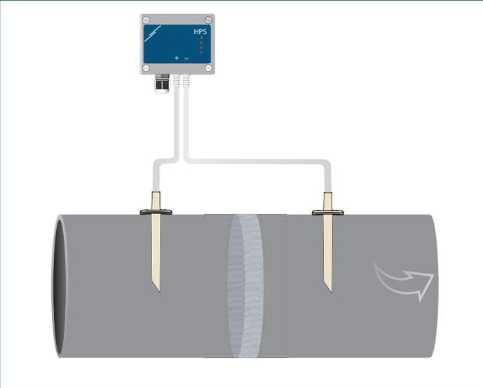
**Applicazione 2: Misurazione del flusso volumetrico \ [m³/h] o della velocità dell'aria \ [m/s] usando PSET-PT**
