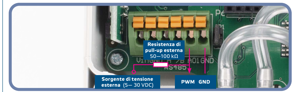
Fig.6 Collegamento PWM (Collettore aperto)
