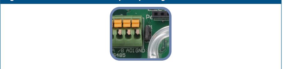
Fig. 5 Ponticello della resistenza pull-up collegato
