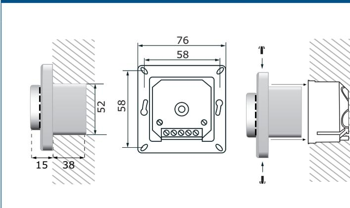
**Fig. 3 Posizione di montaggio**
