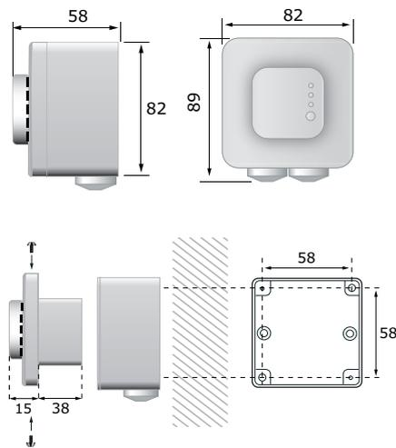
**Fig. 5 Posizione di montaggio**
