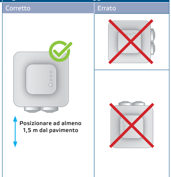
Fig. 5 Posizione di montaggio
